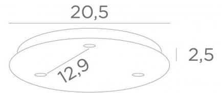
**CEILING BASE 3 o20** est une base au plafond de forme ronde, prévue pour trois sorties de câbles en vue de suspendre des ampoules, des structures, des verres ou des abat-jour
