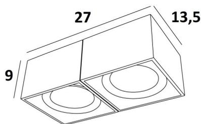
**ATRIA 2 FIXE** est un plafonnier rectangulaire de grande taille avec deux ampoules de 111mm de diamètre, non orientables
