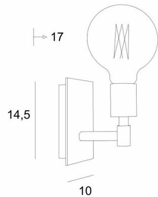
**SINOUE L** ist eine Wandleuchte, in die nur eine dekorative Glühbirne eingesetzt werden kann. Diese Wandleuchte kann auch umgekehrt mit der Glühbirne nach unten angebracht werden. Sie ergänzt eine bereits installierte Pendelleuchte mit dekorativen Glühbirnen. Ein ähnliches Modell mit einem Ring an der Fassung ist für die Anbringung eines **KERMA-Struktur** oder eines traditionellen Lampenschirms vorgesehen, siehe **SINOUE**.
